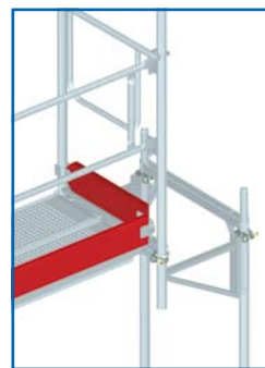
Anwendungsbeispiel Konsole 0,50 m zum Verlängern bzw. Verkürzen
