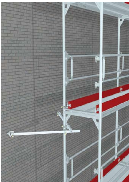
Anwendungsbeispiel Absteifkupplung als V-Anker
