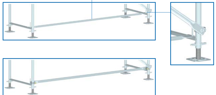
Anwendungsbeispiel Diagonale und Horizontalstrebe
