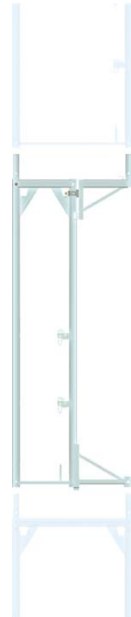
Anwendungsbeispiel Stellrahmen 0,37 m als Auslegerrahmen mit Konsole 0,36 m und Konsole spezial
