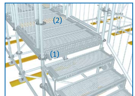
Anwendungsbeispiel Spaltriegel (1) und Spaltabdeckung (2) (Spaltabdeckung siehe Seite 18/19)
